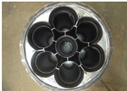
*Innenansicht des Pyrolysators von Abokobi mit sieben Verschmelzrohren*
